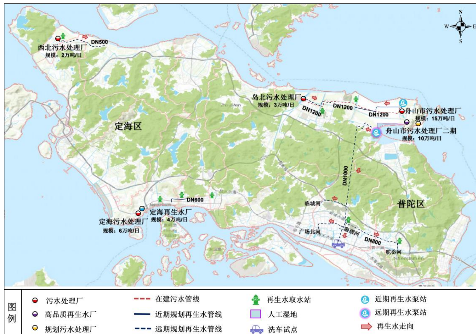
图 6.1-2 舟山本岛再生水利用工程总体图
