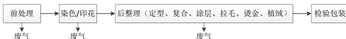
图 6.2-1 总体工艺流程
