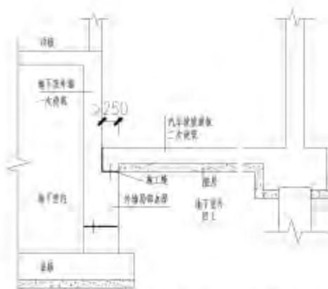
图 18 汽车坡道与地下室外墙交界做法
