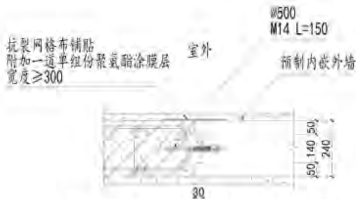
图 61 预制内嵌外墙板竖缝连接节点
