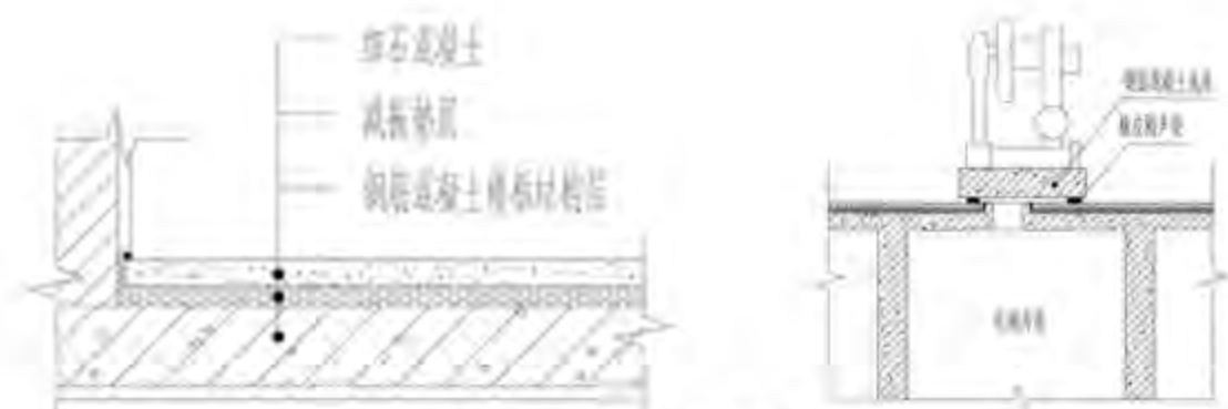
图 64 电梯机房楼面减震措施
