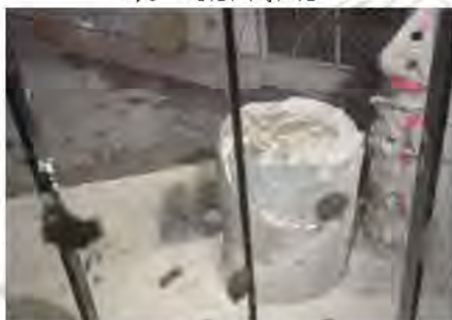
图 10 旋挖机筒钻岩样
