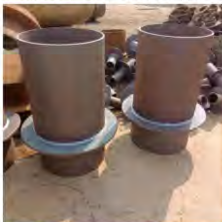
图 46 止水环焊缝饱满
