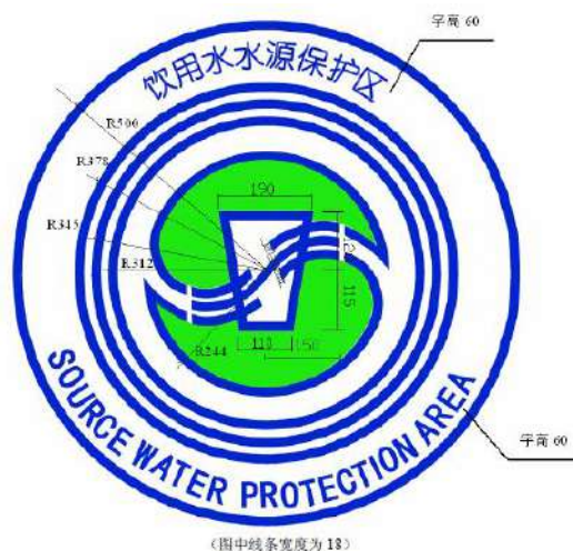
图 6.3-2 饮用水水源保护区图形标志尺寸比例示意图
