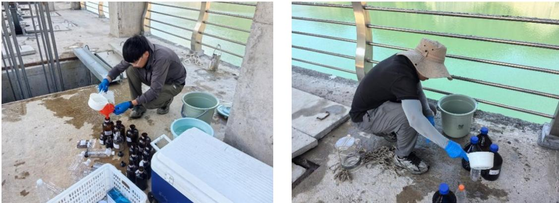
方溪水库取水口全分析采样照片
