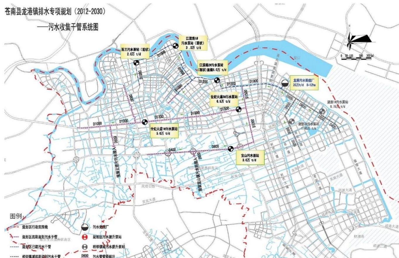
图 2-3 苍南县龙港镇污水收集主干系统图
