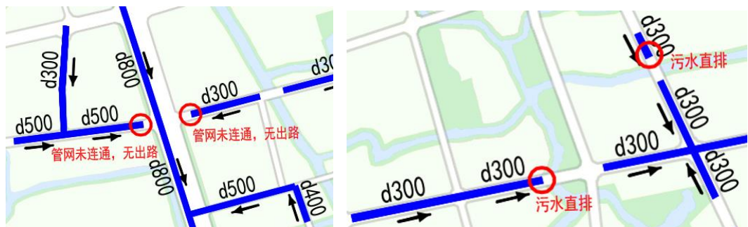
图 4-10 污水断头及污水直排示意图（左：管网断头；右：污水直排）
