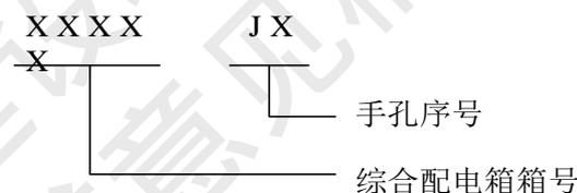
图 E.0.5-3 与综合配电箱连接手孔编码规则示例
